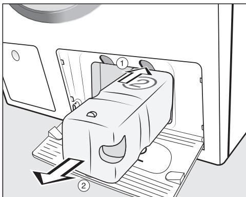
① カートリッジの上の黄色のボタンを押して、ロックを外します。
