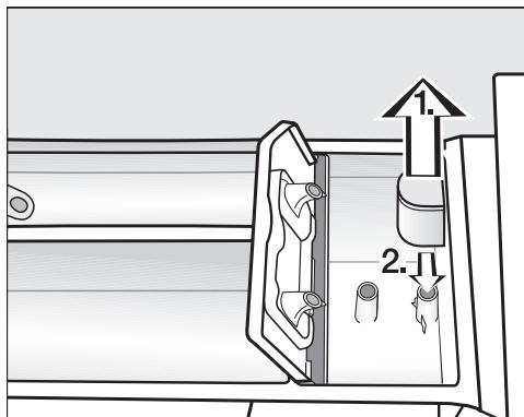
1.  $\bowtie$ の仕切りからサイフォンを取り外し、温水で洗い流してください。同様に、サイフォンがはまっていたサインフォンチューブも洗浄します。
