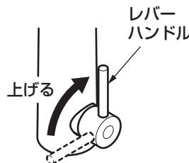
浄水カートリッジを取り付け、レバーハンドルを上げて(水が出ない状態)から通水を再開してください。
