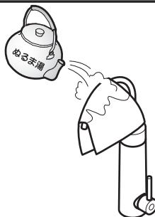
水抜きを行っても吐水口に付着した水滴が凍り、通水再開後も少しの間、水が出ない場合があります。そのときはタオルなどの布を巻き付け、しみこませるようにゆっくりとぬるま湯をかけてください。
