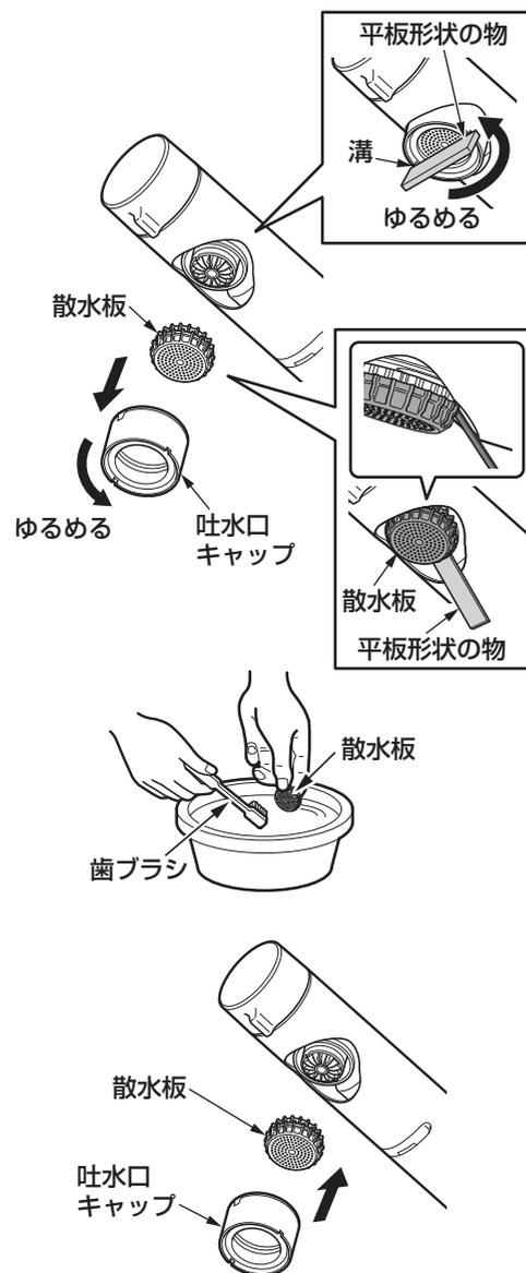
① 平板形状の物（バターナイフなど）を吐水口の溝に差し込み、回して外す。
