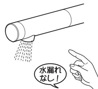
⑤ 掃除が終わったらフィルターを継手先端に取り付け、シャワーヘッドを継手が奥に当たるまで差し込む。
