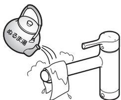
水抜きを行っても吐水口の網目に付着した水滴が凍り、通水後も少しの間、水が出ない場合があります。そのときはタオルなどの布を巻き付け、しみこませるようにゆっくりとぬるま湯をかけてください。
