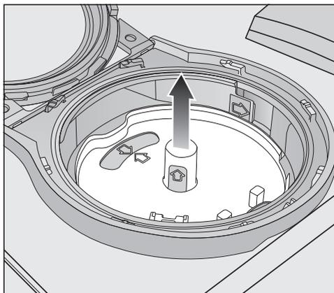
■ パワーディスクホルダーを黄色いタブを引き上げて取り外します。この時、側面のタブを引っ張らないでください。
