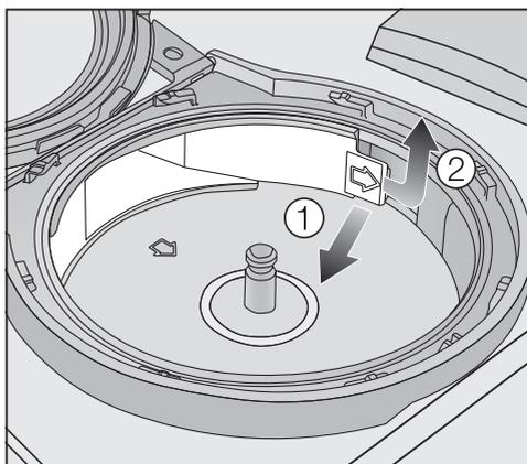
■ タブ (矢印を参照) ① を使って、注入チャンネルを解除し、引っ張って外します ②。
