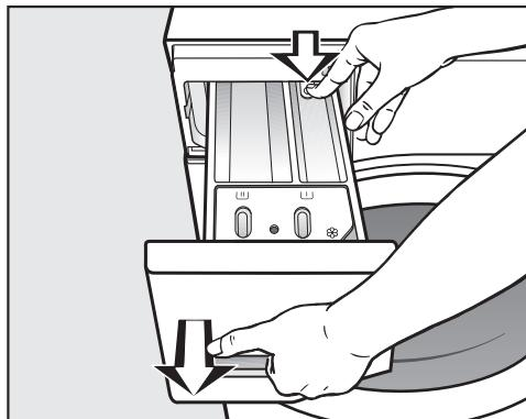
■ 抵抗を感じるまで、洗剤投入ケースの引き出しを引っ張ります。リリースボタンを押し下げて、同時に洗濯乾燥機から引き出しを抜きます。
