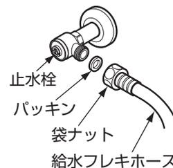
※給水フレキホース内の水が少し流れ出ますので、バケツなどの容器で受けてください。
