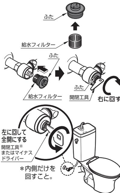
「②止水栓自体にフィルターが付いていないタイプ」は、止水栓に接続されているフィルターユニットの給水フィルターを掃除してください。
