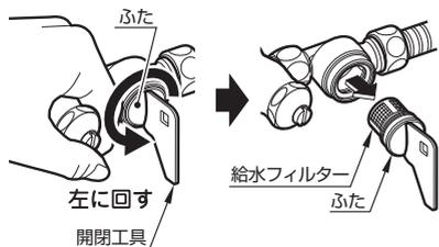
2. 給水フィルターのふたを開閉工具で開けて、給水フィルターを取り出す。
