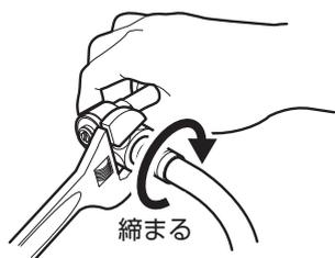
※給水フレキホース内の水が少し流れ出ますので、バケツなどの容器で受けてください。
