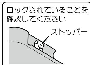
2) 整流板を両手で支えながら手前側を上に持ち上げ、左右のストッパーを押しながらロックします（②）。
