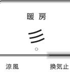
※各運転動作中に他の運転スイッチを操作した場合、浴室換気暖房乾燥機内部で運転切り替えの準備をするため、約10秒～40秒後に運転が切り替わります。
