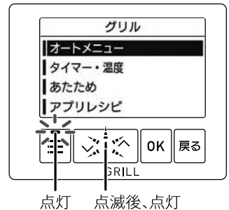
点灯 点滅後、点灯
