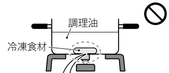
冷凍食材を鍋の底面中央(温度センサーの接触位置)に密着させない
