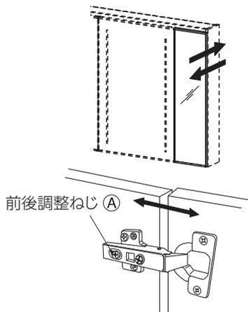
ねじAを右に回すとねじがゆるみます。ねじがゆるんだ状態で鏡扉を奥に押しと鏡扉が後ろに、手前に引くと鏡扉が前に動きます。調整した後、ねじAを締め直します。
