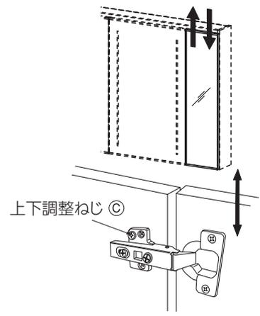
ねじCをゆるめて鏡扉を上下に調整した後、ねじCを締め直します。
