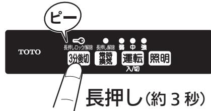
お手入れ終了後は再び [3分後切] スイッチを「ピー」と音が鳴るまで約3秒間押し続けてスイッチの「ロック」を解除してください。「ロック」を解除すると、弱、中、強の風量表示ランプは消灯します。
