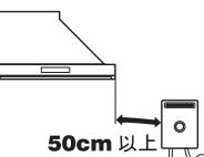
IH クッキングヒーター（電気コンロ）を使用時、レンジフードがあたたまりにくいため、結露（水滴）が生じることがあります
