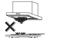
ガス湯沸かし器周辺はかなり高温になるので 50cm 以上離してください。湯沸器の上部には絶対にレンジフードを取り付けないでください。製品の損傷や高熱による故障の原因となります。
