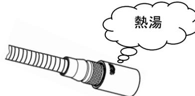
破損、変形、変色の原因になります。メッキ面の剥がれやキズでケガをする恐れがあります。
