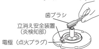
※電極(点火プラグ)の先端はとがっていますので、けがなどに注意してください。
