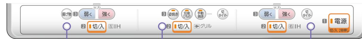
レンジフード連動システムは、上面操作部の送信部(3カ所)から発信した赤外線信号をレンジフードが受信して動作します。送信部・受信部が汚れたり、信号がさえぎられたりすると、レンジフードが動作しない場合があります。
