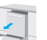
●下に引き出しがある場合、引き出しへ開けたまま本機のドアを開けない。(引き出しや本機の破損の原因)
