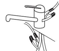
水栓や給水・給湯管が発熱し、破損して家財などをぬらす財産損害発生のおそれがあります。
