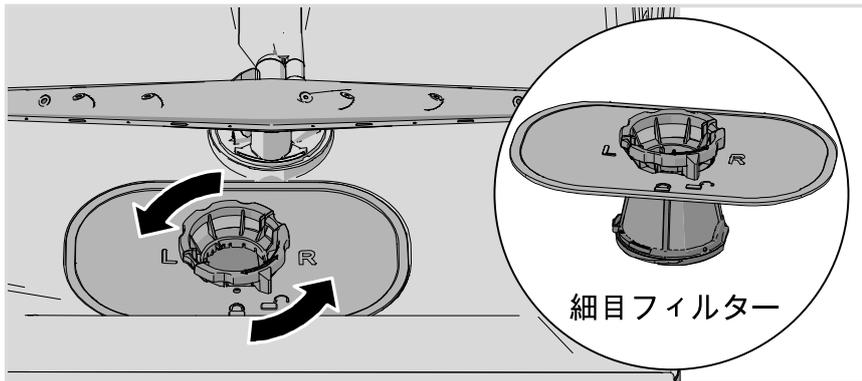
1. ロックリングを反時計廻りに回し、細目フィルターをまっすぐ持上げて取外します。
