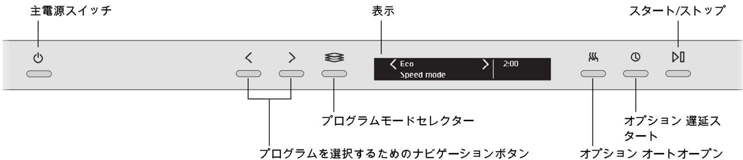
食洗機を据付ます (「据付」の章を参照)。据付後、ドアを開けて主電源スイッチを押すと、食洗機の使用が出来ます。
