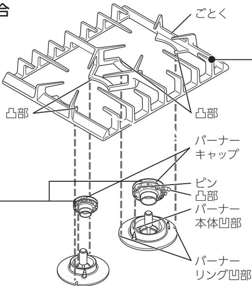
**2.** リング部の「小」を手前にして、バーナーリング前後の凹部2カ所にごとく内側の凸部2カ所を入れて、正しく取り付ける。
