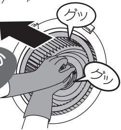
※羽根が完全に挿入されていないと、羽根が外れる原因になります。
