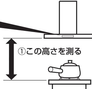
① レンジフードの下端と調理機器上部（鍋を置くところ）の距離を測る。
