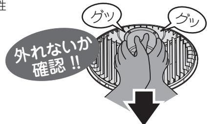
※羽根が完全に挿入されていないと、羽根が外れる原因になります。
