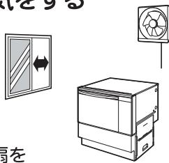
使用中は窓を開けるか、換気扇をまわして部屋の空気を入れ替えてください。不完全燃焼などで、一酸化炭素中毒の原因になります。
