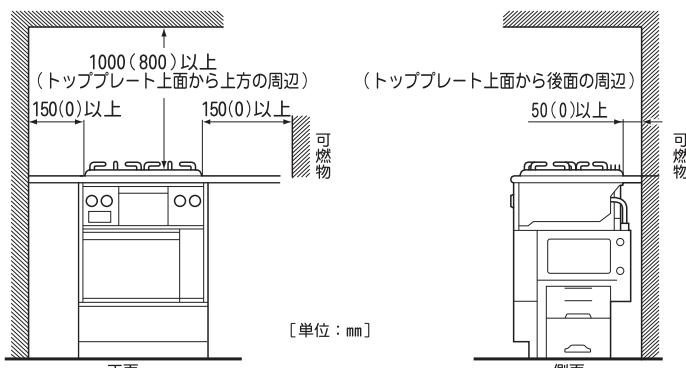
※( )内は、周囲の壁が不燃材料で有効に仕上げた部分
