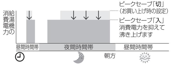
ダブルピークカット設定をする / 夜間沸き上げ時間をずらす / ピークセーブする
