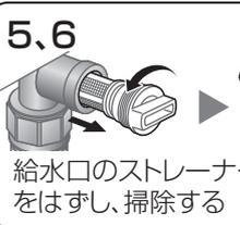
給水口のストレーナーをはずし、掃除する
