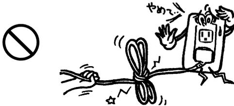
重いものを載せたり、はさみ込んだりすると、コードが破損し、火災・感電の原因になります。
