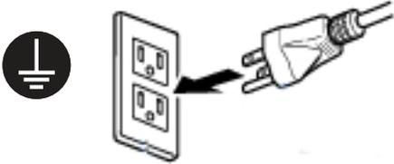
故障などの漏電により感電する恐れがあります。アース工事は必ず電気工事店に依頼してください。
