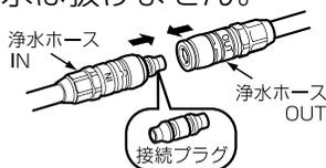
4. ホース（OUT）をカートリッジから外し、接続プラグを接続し直した後、水抜逆止弁ASSYのボタンを押して配管内の水を抜きます。
