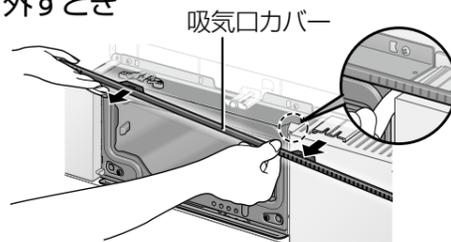
隙間に指をかけて、吸気口カバーを引き抜く
