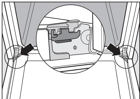
ドアが水平になっているときに、固定具から取り外そうとしないでください。ばねでストッパーが閉じ、本体に損傷を与えます。
