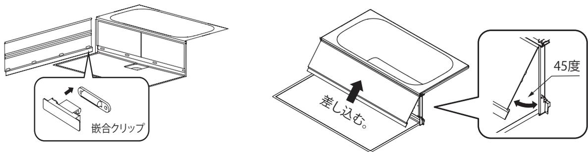
6. とってもクリンカウンターの天板を取り付ける際は、天板の手前側をブラケットの先端にくわえこませた後、奥側が「バチッ」と音が鳴るまで、上からゆっくりと押し込む。
