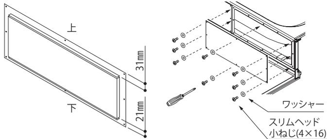
**注意** 点検口の取り付けがずれていたり、点検口が緩んでいると、水漏れする恐れがあります。
