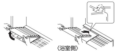
**注意** ・レールを取り外す際は、浴室側から持ち上げて外してください。傷や破損の原因になります。
