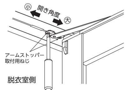
開き角度を小さくしたい場合は、取付穴位置を吊元側に、大きくしたい場合は取付穴位置を戸先側に変更してください。
