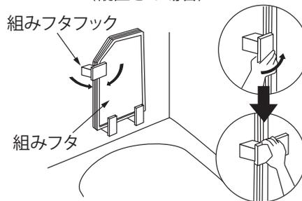
**注意** 上のフックは、自重では回転しません。必ず上のフックを手で回転させて、組みフタが落ちないことを確認してください。
