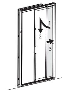
**注意** 扉の取り外し、取り付けは脱衣所側から作業してください。傷や破損の原因になります。
