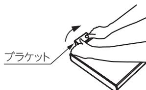
2. エプロン外カバー下側付近のすき間に指を差し込み、手前に引いてエプロン外カバーを外す。
