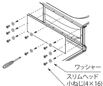
4. エプロン点検口の上下の向きに注意して、スリムヘッド小ねじとワッシャーを手回しドライバーを使用して確実に取り付け。
