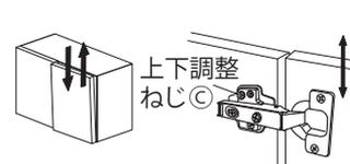
ねじ③をゆるめて扉を上下に調整した後、ねじ③を締め直します。
