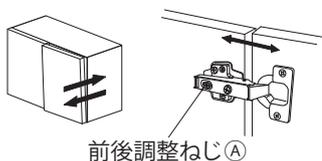
ねじ①をゆるめ、扉の前後を合わせた後、ねじ①を締め直します。
