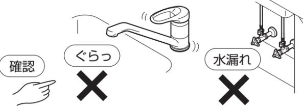
漏水を確認した場合は、止水栓または配管中の元栓を閉めてください。
