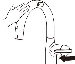
正常な温度調節を行うために、給湯圧力を給水圧力より低くするか、同圧にしてください。給湯圧力を加圧する場合も同様です。
