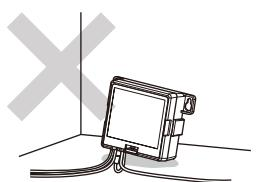
付属の電源(ACアダプタ)以外は使用しないでください。また、付属の電源(ACアダプタ)を他の製品に使用しないでください。
