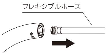
④フレキシブルホース先端にあるストレーナキャップをはずします。
