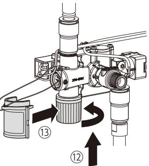
⑬水抜き栓カバーを矢印の方向に差し込みます。
