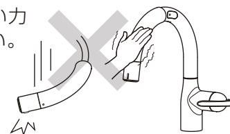
浄水器部やレバーハンドルに重い物を下げたり、力をかけて回したりしないでください。部品の破損の原因になります。
