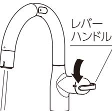
湯を使うときは、必ず水側から吐水し、ゆっくり湯側に回して温度を調節してください。
