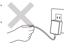
電源プラグ(ACアダプタ)のケーブルが傷んだり、コンセントへの差し込みがゆるいときは使用しないでください。
