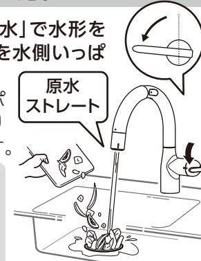
「浄水」や「シャワー」、「温水」でディスポーザーを使用すると、吐水量不足により粉碎物が配管に詰まる可能性があります。
