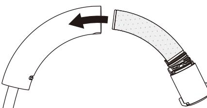
新しい浄水カートリッジを取り付けたら、「浄水」で約1分以上水を流してください。
