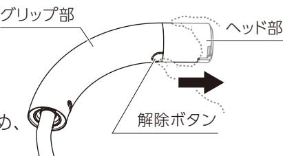
※必ず引き抜く側の手で解除ボタンをしっかりと押してください。
