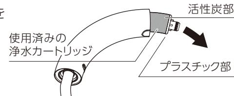
ヘッド部をはずす際に、浄水カートリッジが一緒に出てきた場合は、浄水カートリッジのプラスチック部を持って引き抜いてください。活性炭部を持って引き抜くと、プラスチック部と分離して浄水カートリッジが破損し、浄水カートリッジの交換ができないことがありますので注意してください。
