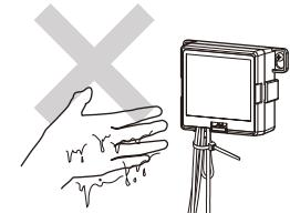
雷が発生しているときは、電源プラグ(ACアダプタ)に触らないでください。
