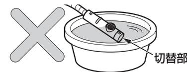
水没させると、切替部に水が浸入し、故障の原因となります。
