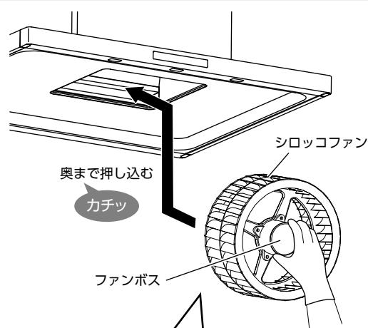
シロッコファンの取りはずし・取付けがかたい場合や、作動音が気になる場合、また、モータ軸のサビ防止には、市販のワセリンをモータ軸の表面にうすく均一に塗ると効果的です。
