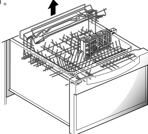
②回転ノズル・タワーノズルをはずします。
