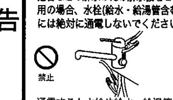
通電すると水栓や給水・給湯管が発熱し、破損して家財などを漏らす財産損害発生のおそれがあります。
