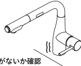
がたつきがないか確認
