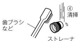
清掃後は逆の手順でストレーナ・ソケットを取付けてください。また、ストレーナを締め込むときは湯水切換ハンドルを吐水口側にしてください。
