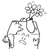
●こぼれた水で電気部品の絶縁が悪くなり漏電火災の恐れがあります。
