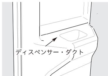
ディスペンサー・ダクトは、アイスバスケットの氷をディスペンサーに送るためのダクトです。故障の原因になりますので絶対に、食材や異物、液体等を入れないでください。ディスペンサー・ダクトの上のドアラックから、物が落ちないように注意してください。
