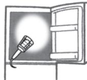
●庫内では、電気製品を使用しない。冷媒が漏れると接点の火花により発火・爆発の原因になります。
