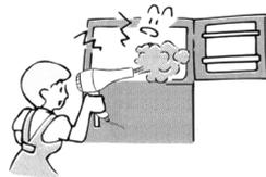
●配管の損傷や万一可燃性冷媒が漏れていた場合、発火・爆発のおそれがあります。
